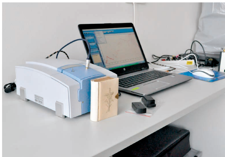
Identifikace materiálu desek knihy pomocí FTIR spektrometru. Foto: Oddělení vývoje a výzkumných laboratoří NK ČR
