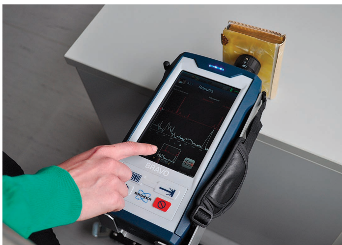
Identifikace materiálu desek knihy pomocí FTIR spektrometru. Foto: Oddělení vývoje a výzkumných laboratoří NK ČR
