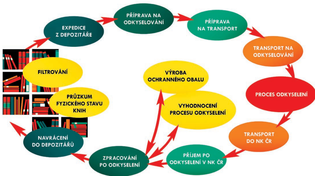
Schéma workflow použitého pro realizaci zakázky na odkyselování knihovních dokumentů.
