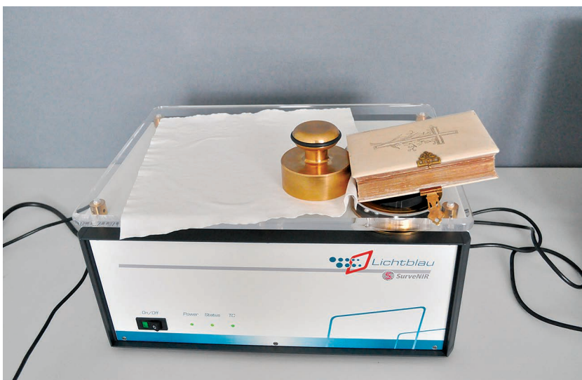
Identifikace desek knihy pomocí systému SurveNIR. Foto: Oddělení vývoje a výzkumných laboratoří NK ČR
