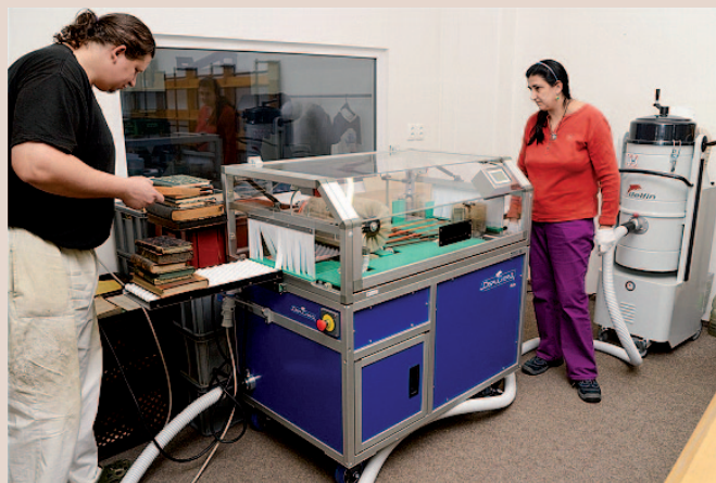
Stroj na očistu knihovních fondů DEPULVERA. Foto: Petra Vávrová
